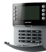
La tastiera è un componente del sistema JABLOTRON. Serve per il controllo e l'indicazione dello stato attuale del sistema. È dotata di quattro segmenti. Le loro descrizioni sono visualizzate sul display LCD. Il dispositivo deve essere installato da un tecnico qualificato con un certificato valido rilasciato da un distributore autorizzato. La tastiera è compatibile con i seguenti pannelli di controllo JA-102K, JA-103K e JA-107K.
